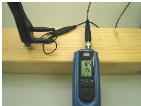
Figura 4-1 Medición transversal al sentido de la fibra con M 20
